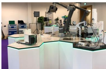
Die einzelnen wabenförmigen Module des Laborsystems iHex lassen sich flexibel anordnen und per Plug-and-Play zu einem Gesamtsystem vernetzen (Foto: TU Dresden – SmartLab-Systeme)
