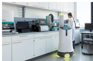
Der mobile Laborroboter Kevin ermöglicht automatisierte Arbeitsabläufe im Labor. (Copyright: Fraunhofer IPA / Rainer Bez)
